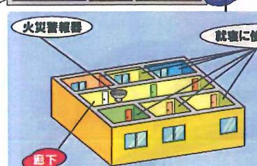
配線式、配線による電源供給が必要ですので新築住住宅向きです
