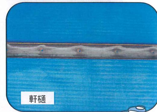
瓦は緩いI字型なので、一点に集中して雨が落ち、等間隔で穴があいています
